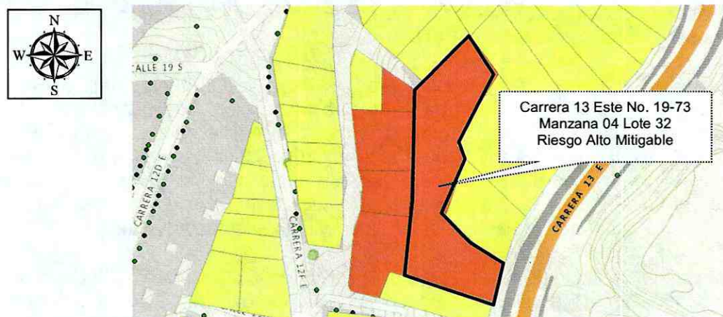
Figura 1. Localización y zonificación del riesgo por fenómenos de remoción en masa. Tomado CT-8022 (Tomado del SIGPREDIAL y complementado).
