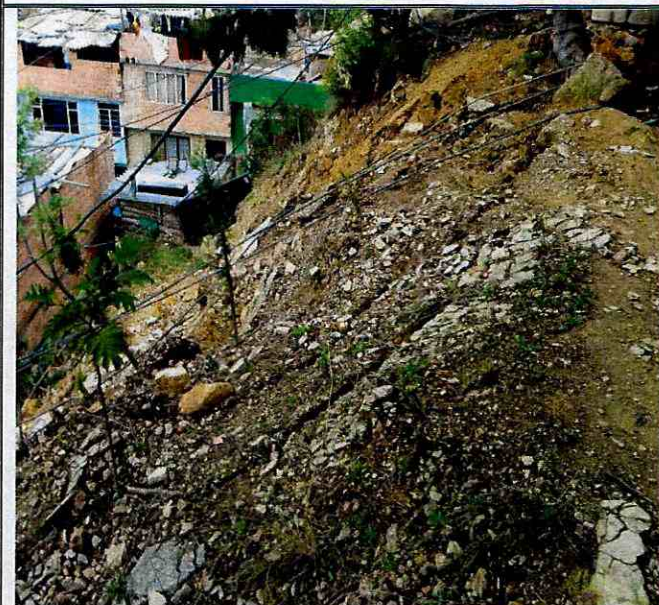
Fotografía 7. Grietas de tracción ubicadas en la parte alta de la ladera ubicada al costado oriental de las viviendas localizadas en el punto con coordenada de localización Punto 2 X:106505.28 Y:115831.59.
