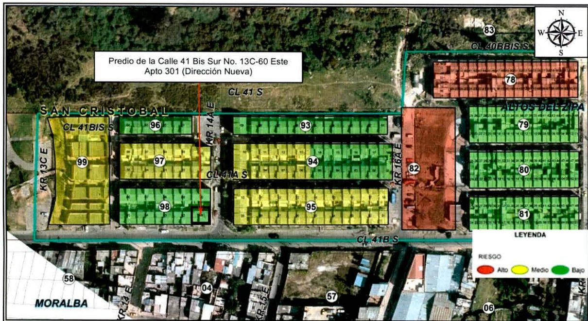
Figura 1. Localización y categorización de riesgo medio por movimientos en masa, para el predio de la Calle 41 Bis Sur No. 13C-60 Este, en la Urbanización Ciudadela Santa Rosa, en la Localidad de la San Cristóbal (Imagen tomada del CT-6889)
