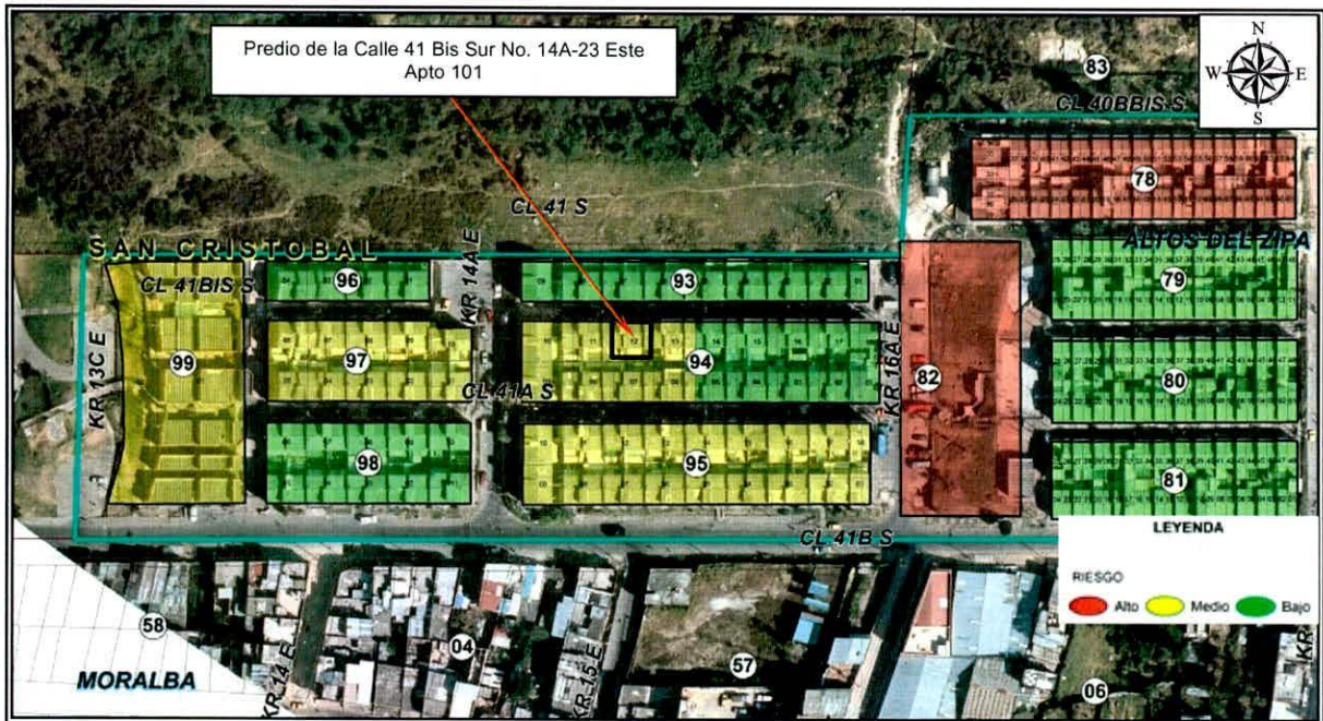
Figura 1. Localización y categorización de riesgo medio por movimientos en masa, para el predio de la Calle 41 Bis Sur No. 14A-23 Este, en la Urbanización Ciudadela Santa Rosa, en la Localidad de la San Cristóbal (Imagen tomada del CT-6889)
