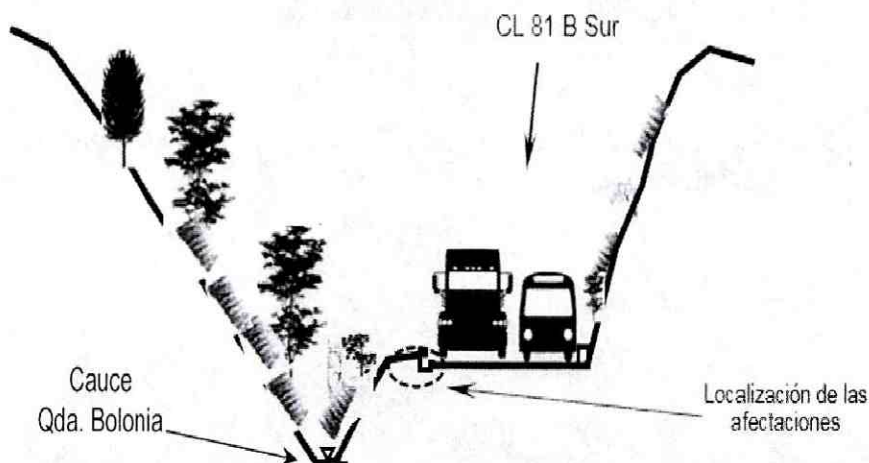
Figura 3. Corte A-A'. Localización de la calzada de la Calle 81 B Sur, la Quebrada Bolonia y pendientes aproximadas de los taludes contiguos (Imagen suministrada por SIG- IDIGER).
