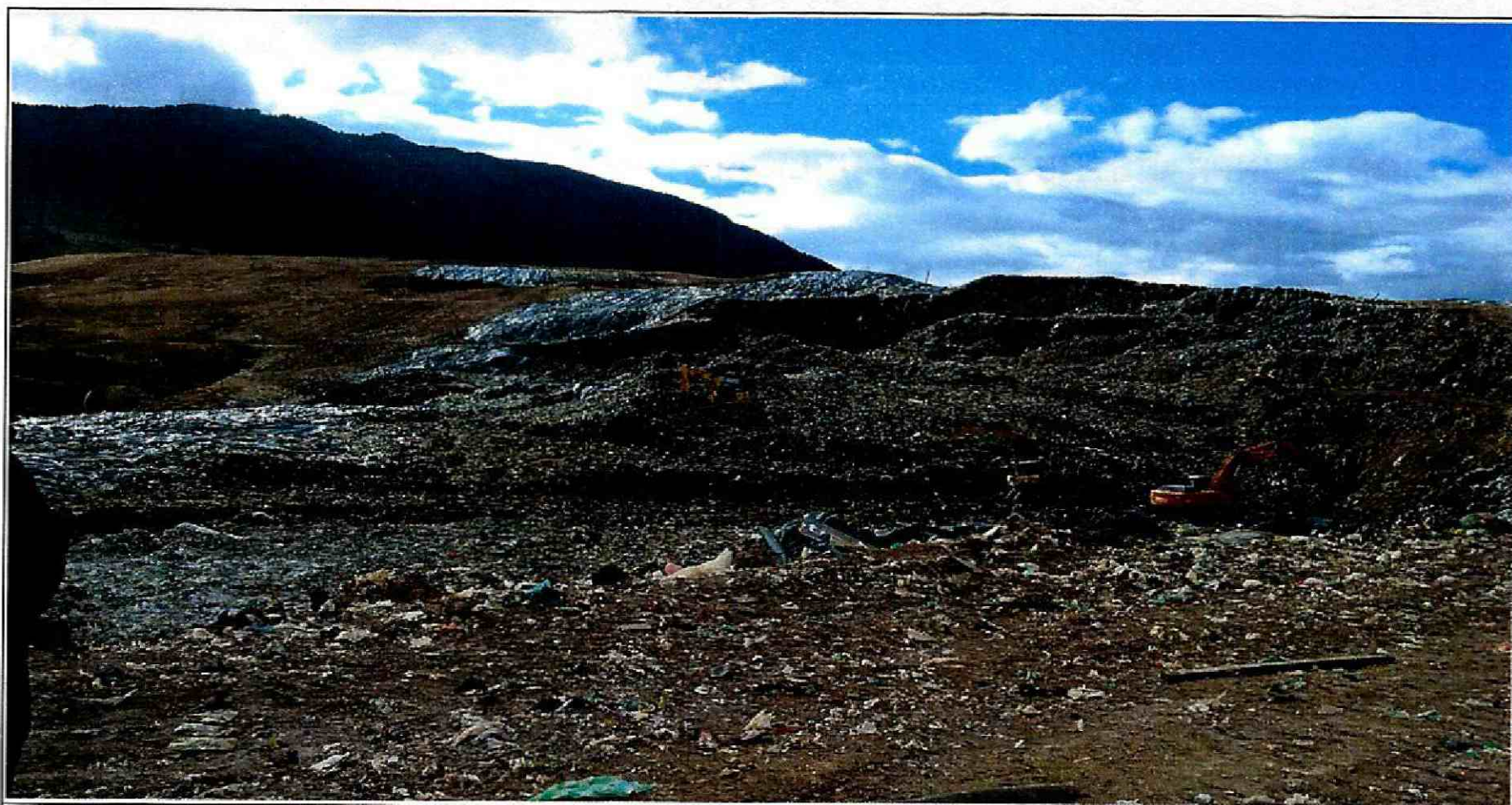
Fotografía 3. Formación de bloques independientes, evidencia de desintegración del material inestable.
