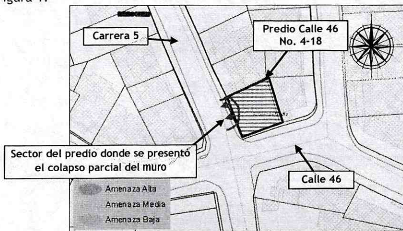
Figura 1. Localización y calificación de amenaza por Fenómenos de Remoción en Masa del predio Calle 46 No. 4-18 ubicado en el Sector Catastral Pardo Rubio de la Localidad de Chapinero. (Decreto 190 de 2004, por el cual se compilan los decretos 619 de 2000 y 469 de 2003)
