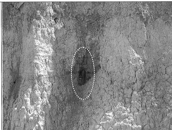
Foto 14 y 15. En el sector evaluado aflora en superficie un estrato de limo de aproximadamente 3 de espesor, subyacente por un depósito aluvial de gran espesor. Según lo observado el estrato de limo es altamente susceptible a presentar erosión por el flujo de escorrentía superficial y subsuperficial.
