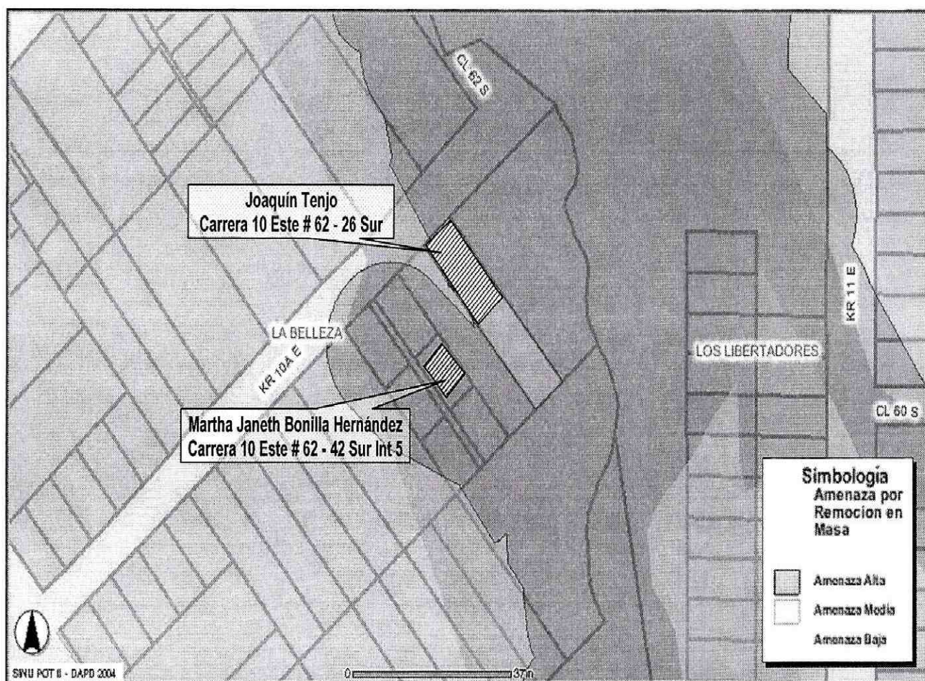
Figura 1. Localización de los predios de la Carrera 10 Este # 62 - 43 Sur Int. 5 y de la Carrera 10 Este # 62 - 26 Sur Barrio La Belleza en el Mapa de Amenaza por Remoción en Masa del POT. Se encuentran en Amenaza Alta.
