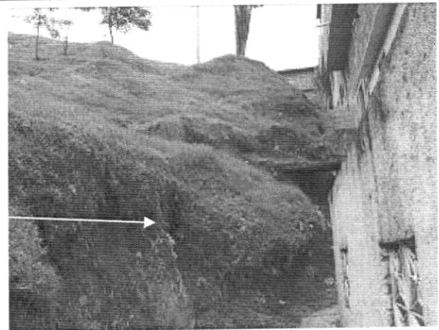
Fotografía 2. Deslizamiento traslacional sobre depósitos de relleno. Los habitantes retiraron material deslizado para acceder a sus casas.
