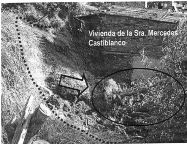
Fotografía 1. Aspecto del deslizamiento, la línea punteada indica el escarpe principal y la flecha indica la dirección del movimiento, nótese el árbol caído.
