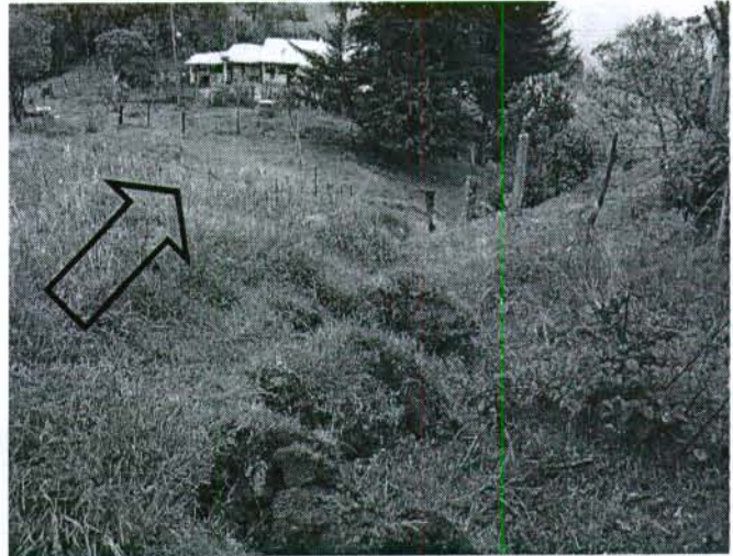
Fotografía 6. Flanco derecho de un flujo de tierras relativamente lento de la zona de acumulación. Nótese la superficie de falla, al fondo se aprecia la casa.
