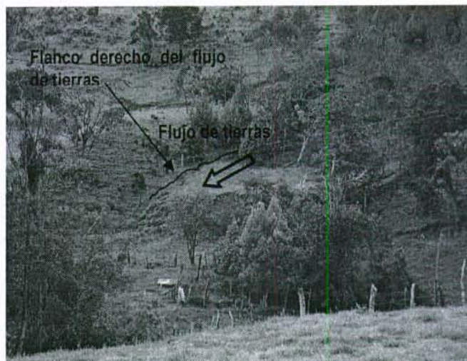
Fotografía 2. Zona de acumulación del deslizamiento principal donde se encuentra un flujo de tierras relativamente lento, nótese la inclinación de algunos árboles.
