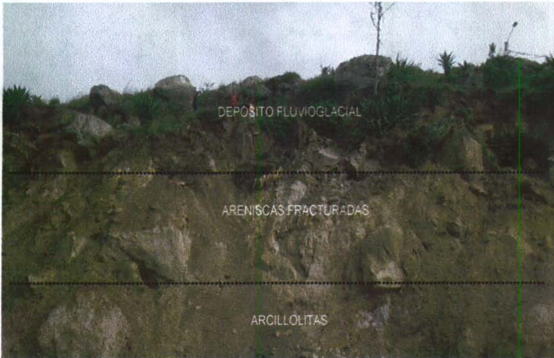
Fotografía 1. Estratigrafía que se presenta en el talud de corte de la cantera.
