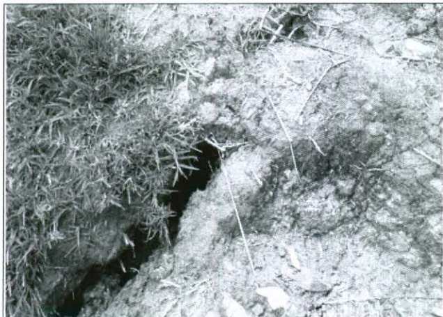
Foto 1. Presencia de agrietamientos en la ladera que evidencian la actividad del proceso de remoción en masa.
