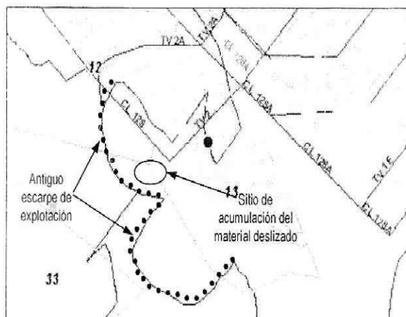
Figura 1. Localización general del escarpe de la antigua explotación y la zona de deslizamiento y acumulación del material deslizado.
