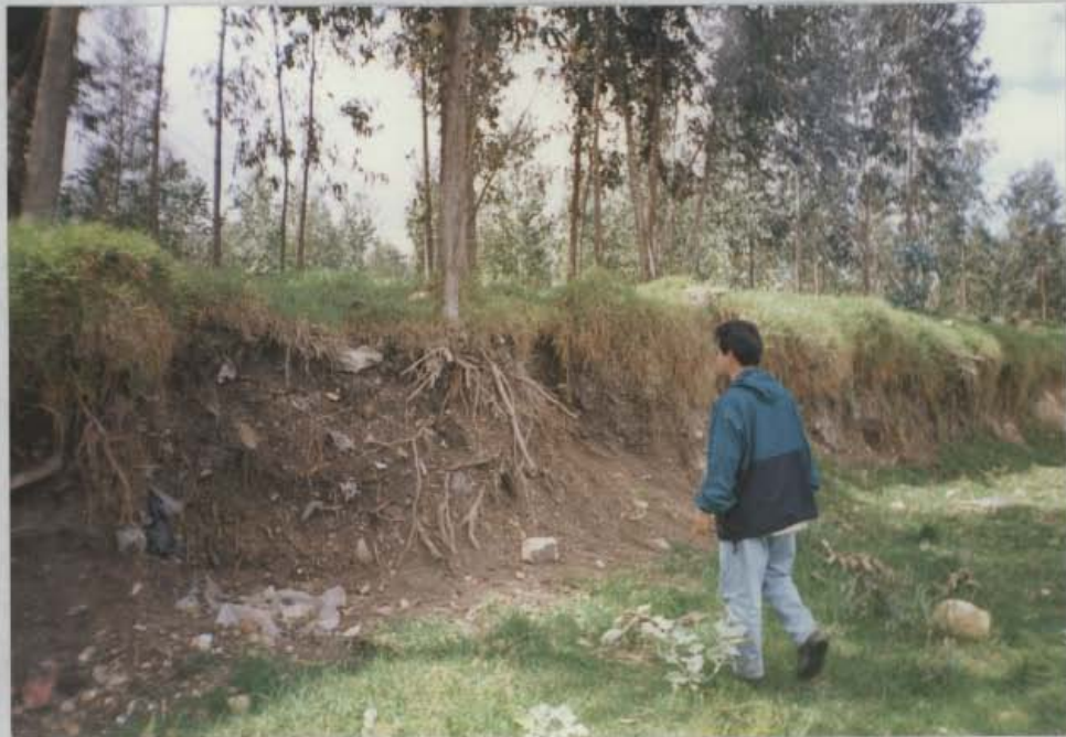
FOTO 2. Obsérvese el depósito de materiales que conforma el lote, correspondiente a origen fluvial.
