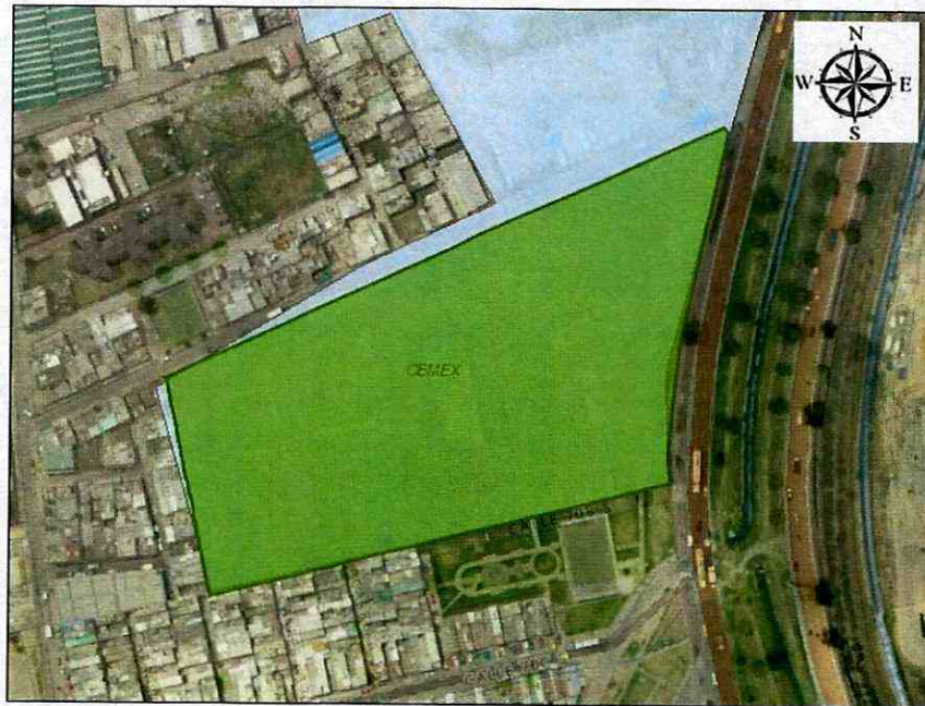
Figura 2. Zonificación de Amenaza para inundación por desbordamiento, para el predio "Alameda – Jardín", el cual se encuentra en una condición de amenaza baja según el POT (decreto 190 de 2004).
