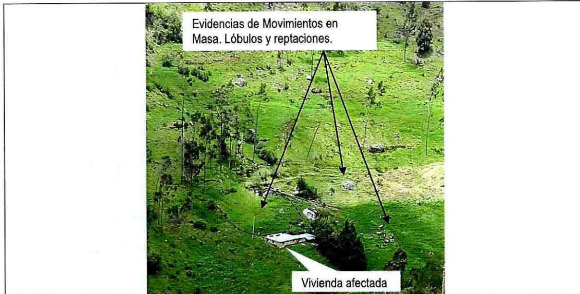
Fotografía 3. Vista panorámica del movimiento en masa compuesto localizado en la finca El Vergelito de la Vereda La Unión de la Localidad de Sumapaz. Tomada el 06/04/2017.
