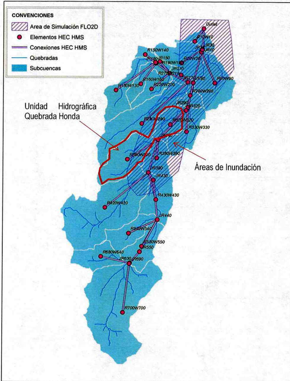
Figura 10. Determinación áreas de Inundación para los diferentes periodos de retorno en la microcuenca Limas, utilizando el software HEC HMS. (Fuente, FOPAE 2007)
