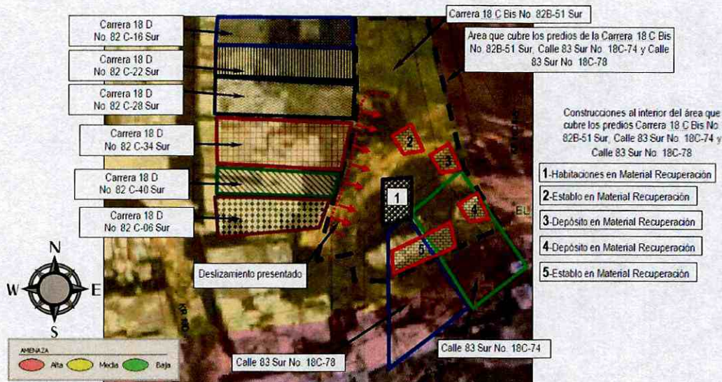
Figura 8. Procesos de remoción en masa identificados en el barrio Arabia
